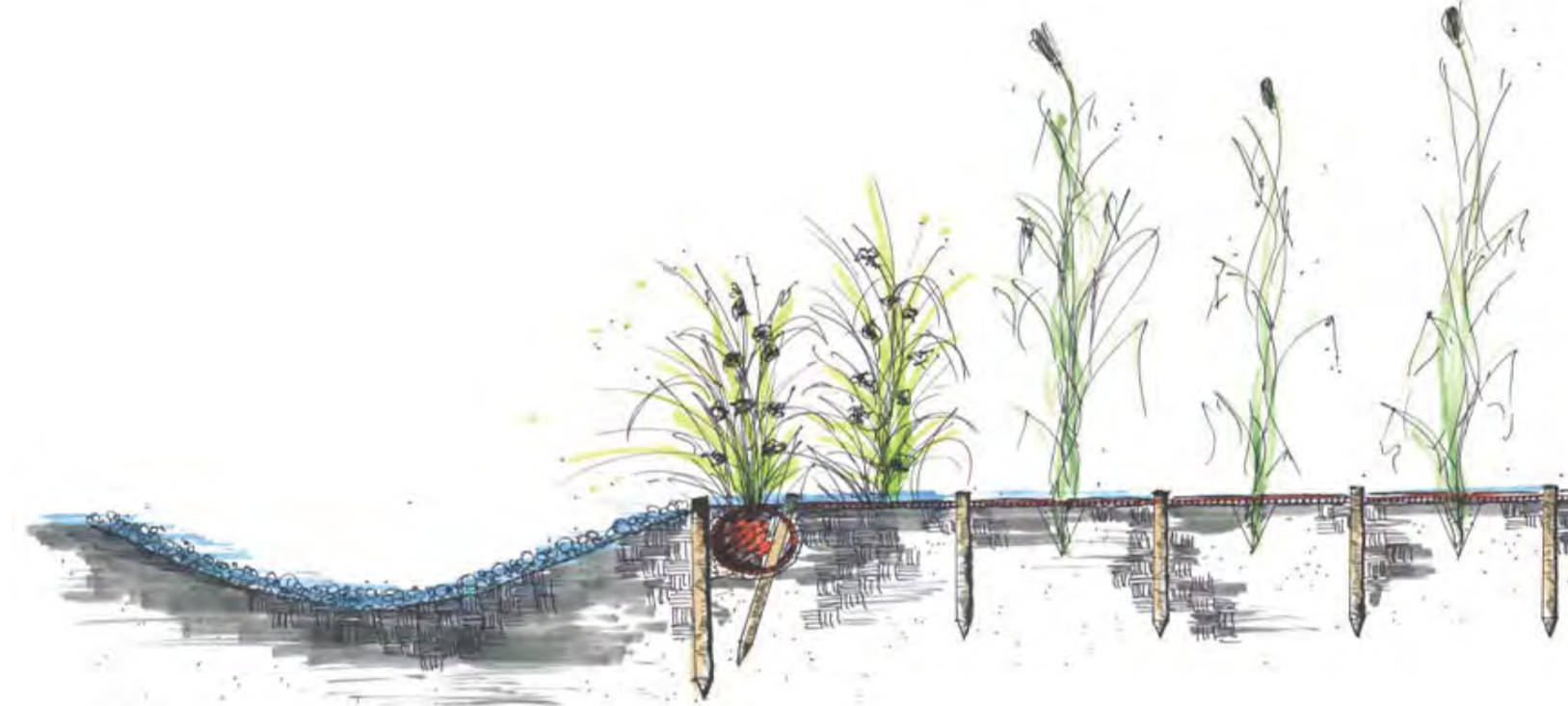
Röhrichtwalze mit geotextilgesicherter Ballenpflanzung
